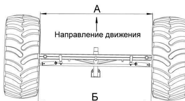
Рисунок 2.23 - Регулировка сходимости колес
